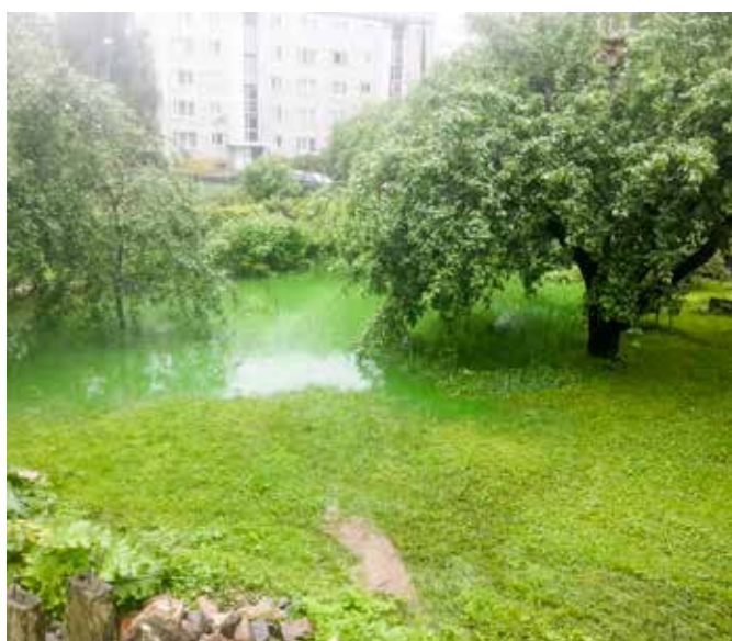
Hidrauliskās pārbaudes laikā siltumtīklu bojājuma vietā iespējama zaļganās krāsas ūdens noplūde.
