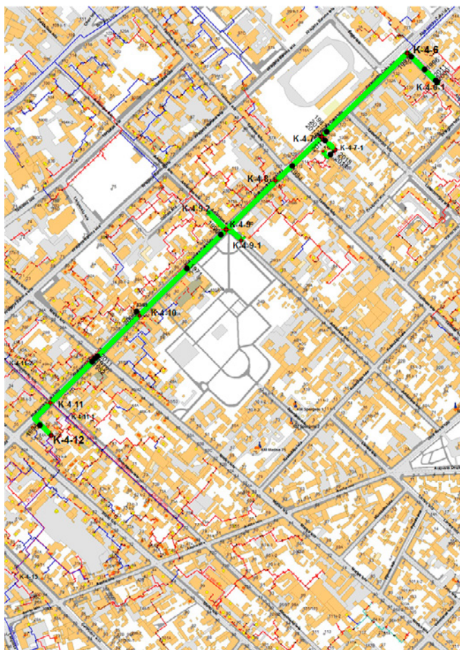
Siltumtīklu pārbūves posms A.Čaka ielā
